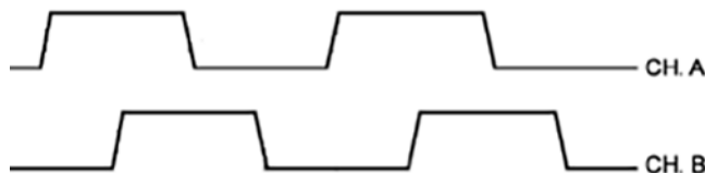
Рис. 4.17: Сигналы на выходе CH A и CH B квадратурного энкодера
