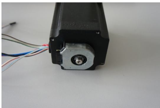
Рис. 3.11: Мотор с прикрепленным энкодером
