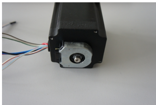
Рис. 3.11: Мотор с прикрепленным энкодером
