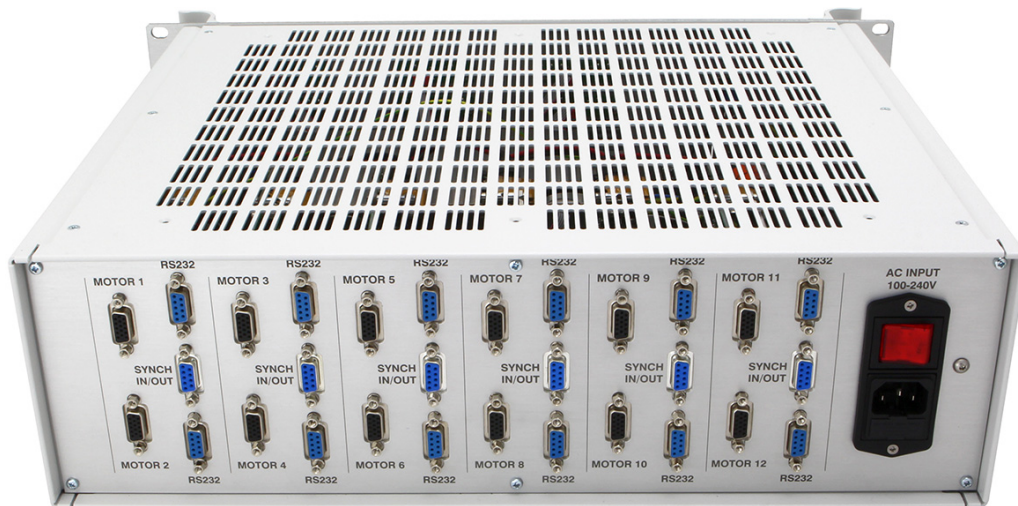
Рис. 7.7: Внешний вид многоосного контроллера движения 8SMC5-ETHERNET/RS232-B19 (вид сзади)
