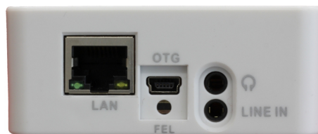
Рис. 7.4: Вид адаптера сзади. Слева направо: Ethernet разъем , mini-USB типа B, кнопка перехода в режим FEL, аналоговые вход/выход для микрофона и наушников
