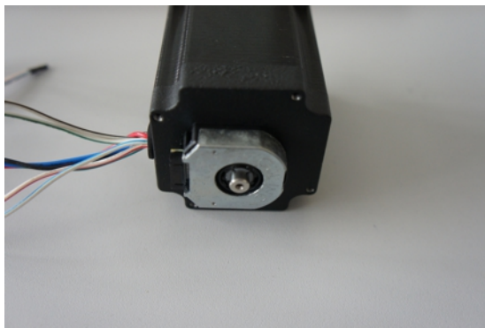
Рис. 3.11: Мотор с прикреплённым энкодером
