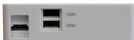
Рис. 7.3: Вид адаптера справа. Слева направо: разъём для микро-SD карты , два разъёма USB type A
