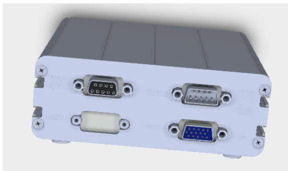
Контроллер в металлическом корпусе, одноосный вариант 3D (модель 8SMC4-USB-B9-1).
