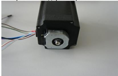
Мотор с прикреплённым энкодером
