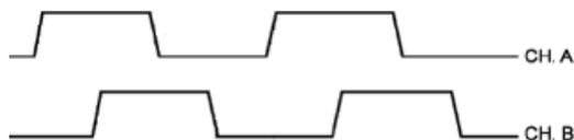
Сигналы на выходе CH A и CH B квадратурного энкодера.
