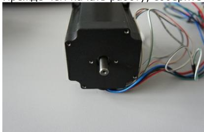
Мотор без энкодера. Обратите внимание на 2 отверстия M2.5 к которым обычно крепится энкодер
