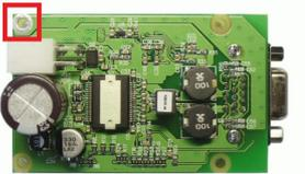
Внешний вид платы контроллера сверху. Красным квадратом отмечена клемма заземления
