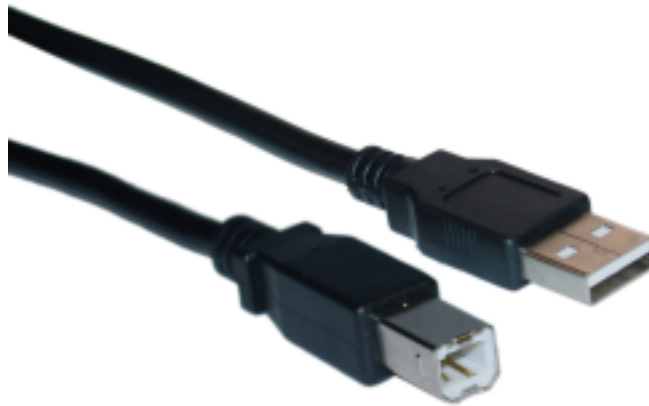
Fig. 4.10: USB type-A - USB type-B cable
